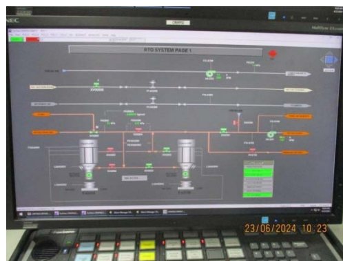
รูปที่ 4 หน้าจอ DCS ติดตามตรวจสอบประสิทธิภาพของ Dust Filter
